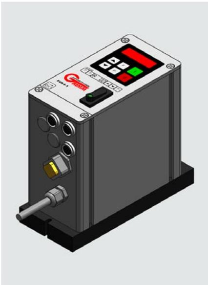
Die Steuerungen vom Typ FUR-S-1 sind speziell für den Betrieb von Schwingförderern konzipierte Frequenzumrichter. Sie erzeugen eine hochstabile Antriebsfrequenz, die schrittweise einstellbar ist. Ein mechanisches Abstimmen des Förderers kann weitgehend entfallen, da sich durch den sinusförmigen Ausgangsstrom bereits ein ruhiges Laufverhalten und somit eine geringe Geräuschkentwicklung ergibt.
